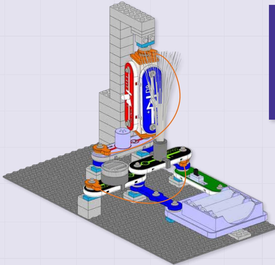
Montez le circuit comme illustré et activez l'interrupteur coulissant (S1). Les quatre DEL (D8, D9, D11 & D12) et la lumière (L4) s'allument. Les blocs-câble 3D permettent aux DEL bleu et clignotante rouge d'être tournées pour illuminer dans la direction de votre choix. Pour un meilleur résultat, placez le sapin de fibre optique sur la DEL de couleur2 (D12) avec sa base, placez l'accessoire lentille sur la DEL de couleur (D8) et tamisez les lumières de la pièce.
