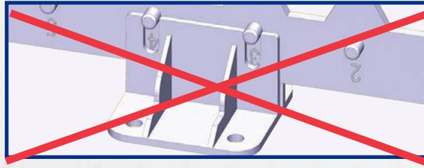
Pour installer un support de base dans une base, alignez les trous du support avec les taquets de la base à l'endroit désiré et appuyez fermement sur le support. Assurez-vous que le support de la base soit solidement installé.
