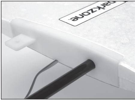
3. Déplacez l'aile sur le tube jusqu'à l'insérer dans la fente du fuselage, tout en plaçant le connecteur de commande d'aileron dans le fuselage.
