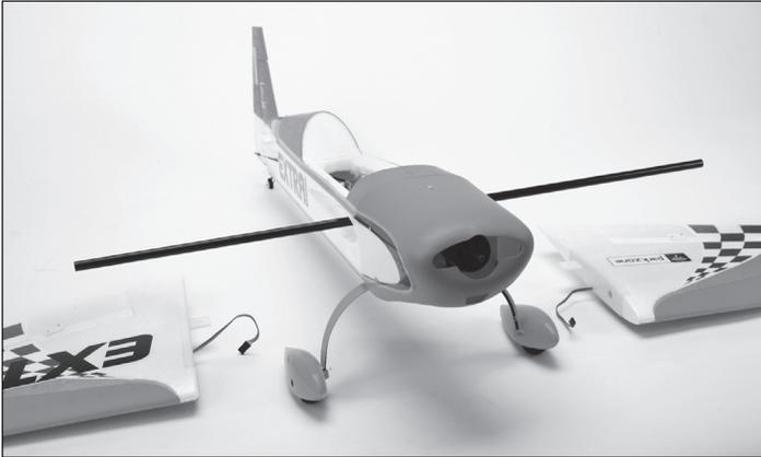
2. Placez l'aile gauche sur la clé d'aile tubulaire.
