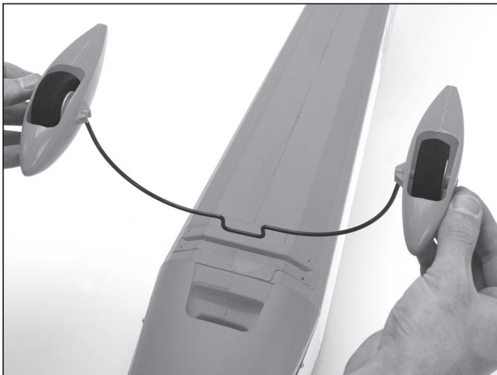
2. Une fois le support complètement installé dans la fente du fuselage, relâchez le train d'atterrissage.
