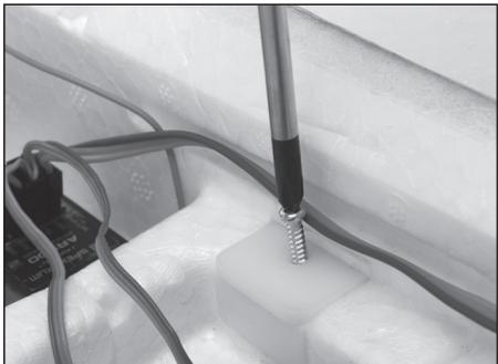
5. Installez l'aile droite en suivant la procédure ci-dessus.
