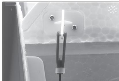
2. Écartez soigneusement la chape et insérez l'ergot dans l'orifice le plus à l'extérieur du guignol de commande.
