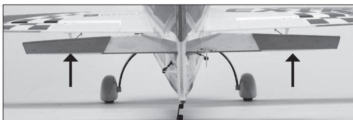
3. Lorsque vous poussez le manche d'aileron de l'émetteur vers la gauche, l'aileron gauche doit se déplacer vers le haut et l'aileron droit vers le bas.
