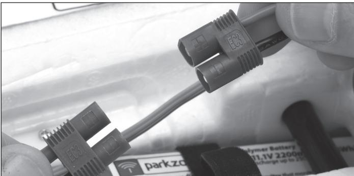
3. Déplacez la batterie dans le fuselage, vers l'avant ou l'arrière, pour ajuster le centre de gravité de l'avion pour le vol.
