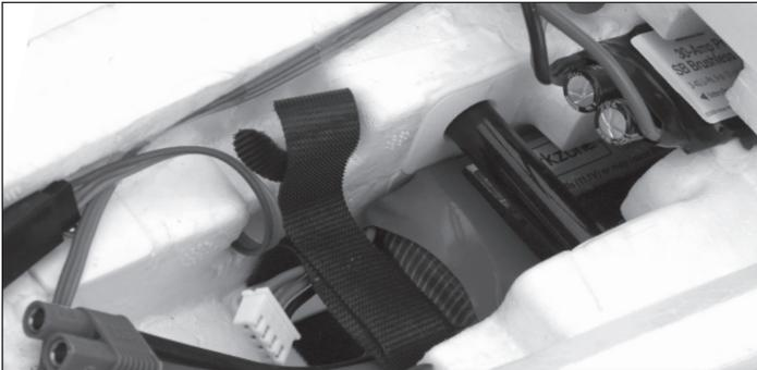
2. Connectez la batterie à l'ESC.
