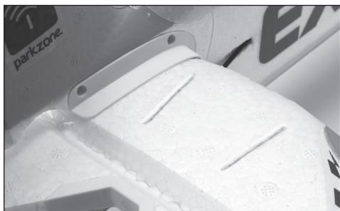
2. Assurez-vous que le centre de l'empennage horizontal est aligné par rapport au centre du fuselage.
