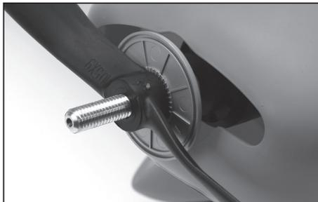
5. Placez l'écrou hexagonal de l'adaptateur d'hélice (PKZ5102) sur la tige de la douille.
