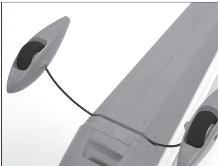
3. Installez les carénages de train d'atterrissage gauche (marqué « L ») et droit (marqué « R ») sur les supports de train et le fuselage à l'aide de quatre (4) petites vis.
