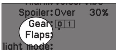
**ASTUCE :** Le petit carré noir signale la position actuelle de l'interrupteur. Faites rouler et cliquez sur la roulette, la case sélectionnée va noircir, indiquant que la valeur ou la condition va interagir à cette position.
