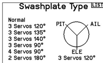
Activez toujours les Expos quand vous utilisez des servos standards rotatifs. L'Expo délivre un mouvement linéaire du plateau à partir du mouvement rotatif des servos standards. Si l'Expo n'est pas activé, le bras du servo va avoir un mouvement courbe qui diminuera la course du plateau aux extrémités de la course du bras.
