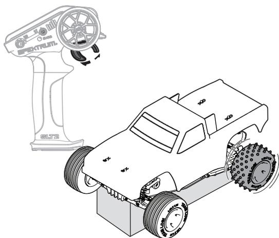
4. Commencez par rouler lentement et si le véhicule ne roule pas droit, réglez la direction à l'aide du potentiomètre du trim de direction.
