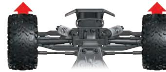
7. Actionnez doucement l'accélérateur pour vous assurer que le véhicule bouge en avant et en arrière et que le moteur s'arrête lorsque l'accélérateur est à la position neutre. Attention : N'accélérez pas à fond en avant ou en arrière tant que le modèle est élevé.
