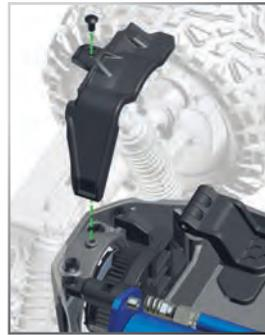
**Position de la vis du moteur dans l'adaptateur d'engrènement fixe pour régler l'engrènement**
