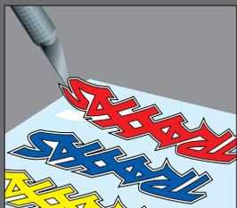
Pour appliquer les décalques, mettez une extrémité sur la surface tout en tenant l'autre entre les doigts, ensuite lissez graduellement le décalque du doigt sur la surface. Ceci empêchera la formation de bulles d'air. Si vous mettez les deux extrémités du décalque sur la surface en même temps et essayez ensuite de le lisser, il y aura des bulles d'air. Regardez les photos sur la boîte pour apprendre la méthode typique d'application des décalques.
