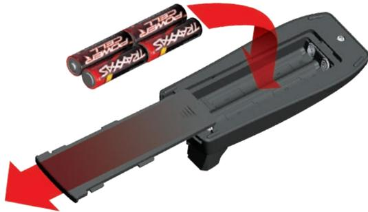
1. Enlevez la porte du compartiment pile en appuyant sur la languette et en faisant glisser la porte pour l'ouvrir.
