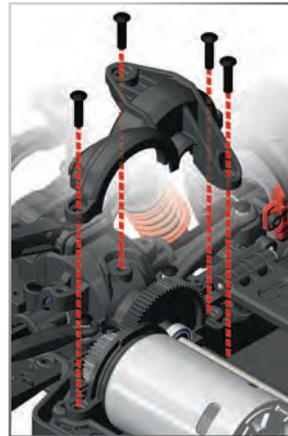
Pour régler l'engrènement, utilisez le tableau à gauche pour identifier les positions des vis sur la plaque du moteur (A - K) qui correspondent aux dimensions choisies des engrènements à pignons du moteur. Retirez les deux vis de la plaque moteur et réinstallez-les dans les positions correspondantes, puis réinstallez l'ensemble de la plaque moteur sur le châssis.
