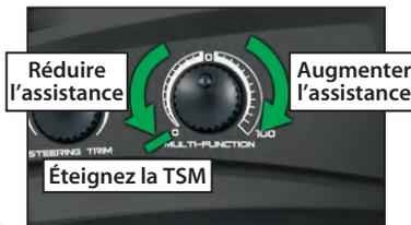
Lorsqu'on conduit sur des surfaces offrant une certaine adhérence, il peut être souhaitable d'atténuer le réglage de la TSM pour obtenir des sensations de pilotage plus « libres » lors des dérapages contrôlés, des glissades, etc. Sur les surfaces offrant très peu d'adhérence (terre meuble, béton lisse, glace/neige), augmentez la TSM pour une accélération et un contrôle maximaux.
