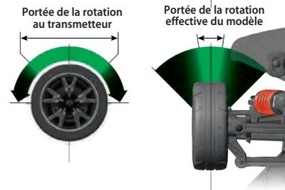
*peut être utile lorsque vous conduisez le modèle sur des surfaces sans adhérence, à de grandes vitesses ou sur des pistes qui favorisent les balayages et demandent des commandes légères du volant. Les plages sont exagérées aux fins d'exemplification.*
