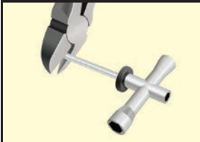
D. Installation/enlèvement du piston
