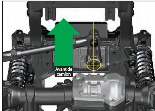
Si vous utilisez des servos du marché des pièces de rechange, il est important d'utiliser les palonniers de servo conçus pour le TRX-6. Les palonniers de servo doivent mesurer 22 mm du trou de montage de la tringlerie de direction au trou de montage du servo.
