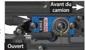
**Différentiel verrouillé :** Allumez le récepteur et le transmetteur. Mettez le commutateur T-Lock à la position la plus avancée pour verrouiller les différentiels intermédiaire et arrière. Confirmez que l'arbre de sortie du servo tourne dans le sens contraire des aiguilles d'une montre pour pivoter le palonnier de servo à la position montrée.
