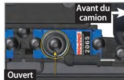
**Différentiel verrouillé :** Allumez le récepteur et le transmetteur. Mettez le commutateur T-Lock à la position centrale pour verrouiller le différentiel avant. Confirmez que l'arbre de sortie du servo tourne dans le sens contraire des aiguilles d'une montre pour pivoter le palonnier de servo à la position montrée.
