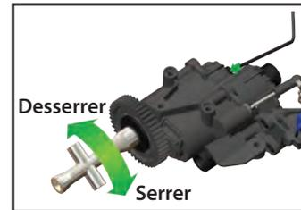
Pour revenir aux réglages d'usine, utilisez la clé en croix fournie pour tourner l'écrou de réglage jusqu'à ce que les quatre rondelles de ressort soient à plat les unes contre les autres, serrez ensuite l'écrou en lui faisant faire un 1/16e de tour supplémentaire (ou jusqu'à ce que l'embrayage à glissement ne permette pas au pignon droit de glisser pendant le fonctionnement normal).
